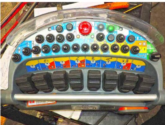
Radio comando per le funzioni di traslazione e perforazione.
